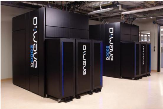
Квантовая ЭВМ D-Wave Systems, 2017 (2000 кубитов)
