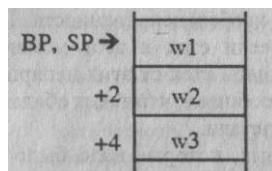
Как видно, адрес третьего слова стека равен адресу вершины стека плюс 4. Учитывая это, делаем следующее: устанавливаем регистр BP на вершину стека и используем выражение [BP+4] для доступа к третьему слову:
