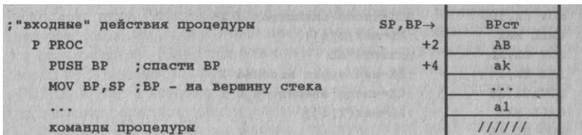
Как видно из рисунка, после записи в стек старого значения BP (BPст) для доступа к параметрам процедуры надо использовать следующие выражения: [BP+4] - для доступа к последнему параметру, [BP+6] - для доступа к предпоследнему параметру и т. д. Например, считывание последнего параметра в регистр AX (AX:=ак) осуществляется командой MOV AX,[BP+4].
