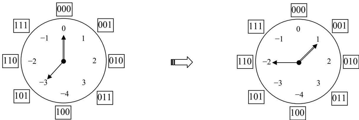
**Для вычитания:** первую стрелку установить на ноль, вторую — на вычитаемое. Зафиксировать угол и совместить вторую стрелку с уменьшаемым. Тогда первая стрелка укажет результат вычитания.
